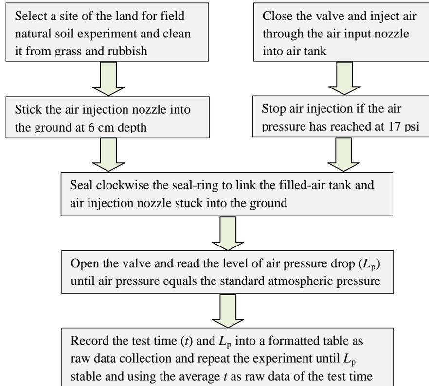
**Fig. 2.** Flowchart of the measurement of air diffusion into the ground by aero-infiltrometer.[Title Page](#)[Abstract](#)[Introduction](#)[Conclusions](#)[References](#)[Tables](#)[Figures](#)[◀](#)[▶](#)[◀](#)[▶](#)[Back](#)[Close](#)[Full Screen / Esc](#)[Printer-friendly Version](#)[Interactive Discussion](#)
