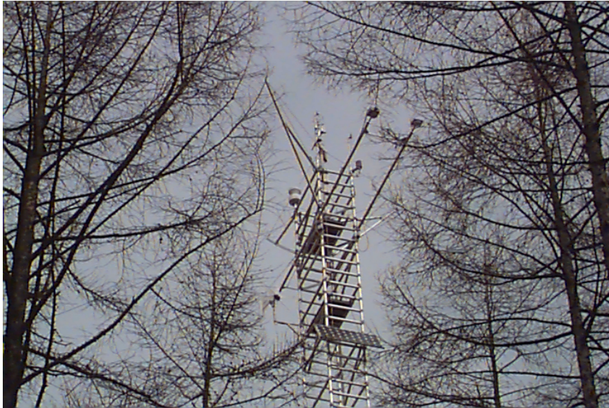
Figure 4: Meetinstrumentatie in het Bankenbos. Boven het zonnepaneel zijn duidelijk de uitgestoken stralingsmeters te zien, daarboven vanaf het hoogste platform de telescoopmast met eddycorrelatie-instrumentatie. Op het hoogste platform vinden de automatische metingen van weersvariabelen, zoals temperatuur en neerslag plaats.
